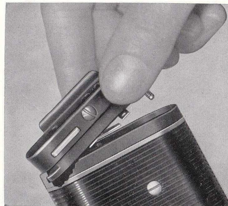
Schmalzunge der Kontaktplatte in die Vertiefung des Gehäuserandes führen, Schraube mit der Münze wieder festziehen.
