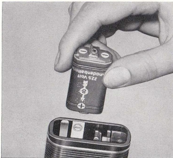
Anoden-Batterie 22,5 Volt wie markiert einlegen, Minuspol nach oben, zur Kontaktplatte weisend.
