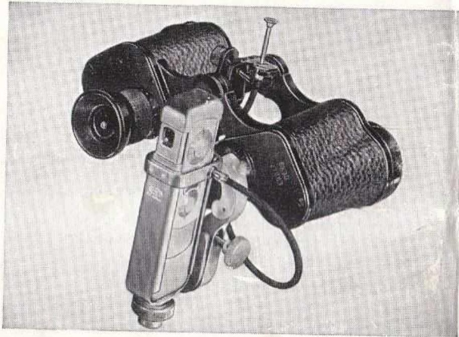
Die eine Hälfte des Feldstechers mit aufgesetzter Camera wird zum Fotografieren benutzt. Die andere Hälfte dient als Sucher, zum Scharfstellen und zur Beobachtung des Motivs. Bei allen Aufnahmen muß die Entfernungsskala der Minox auf  $\infty$  (Unendlich) stehen. Die folgende Gebrauchsanleitung beschreibt getrennt die Verwendung der Minox-Camera mit Feldstechern **mit** und **ohne Mitteltrieb**.
