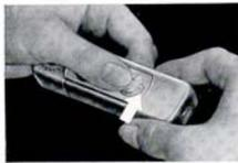
So wird die Entfernung eingestellt. Der Pfeil zeigt auf die Tiefenschärfenklammer
