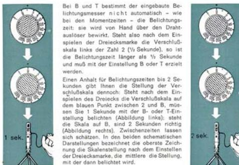
Bei B und T bestimmt der eingebaute Belichtungsmesser nicht automatisch – wie bei den Momentzeiten – die Belichtungszeit; sie wird von Hand über den Drahtauslöser bewirkt. Steht also nach dem Einspielen der Dreiecksmarke die Verschlusskala links der Zahl 2 ( $\frac{1}{2}$  Sekunde), so ist die Belichtungszeit länger als  $\frac{1}{2}$  Sekunde und muß mit der Einstellung B oder T erzielt werden.
