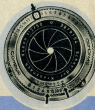
Das richtige Verhältnis von Blendenwert zu Zeitwert ergibt sich automatisch durch die Einstellung des Lichtwertes. Feststellen des Lichtwertes nach Möglichkeit durch Belichtungsmesser oder Belichtungstabelle.
